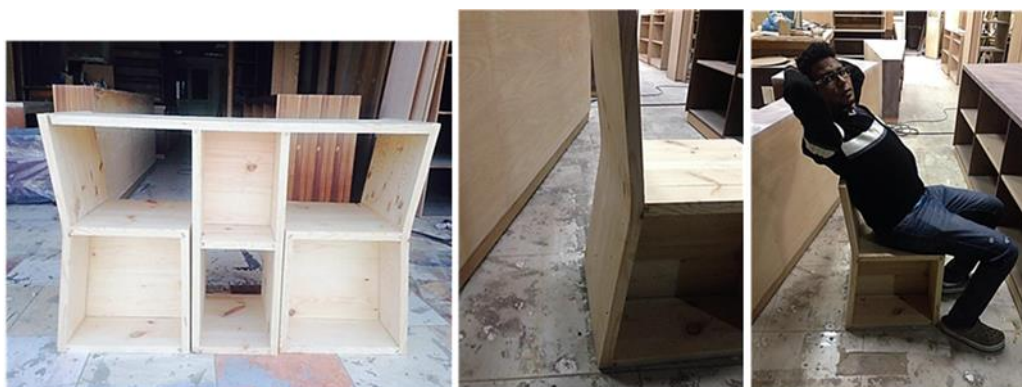
(شكل 23) يوضح أحد الطلاب يقوم باختبار ظهر الكرسي لوحدة المكتبة ذو الكراسي بورشة التصنيع
