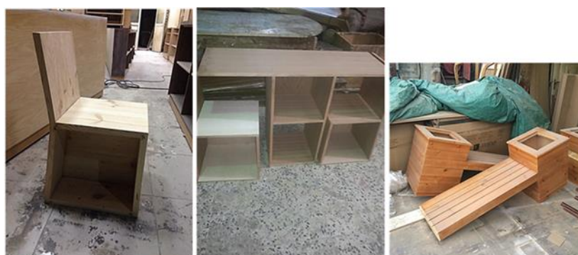
(شكل 22) يبين وحدات المشروع في ورشة التصنيع أثناء مرحلة التجميع
