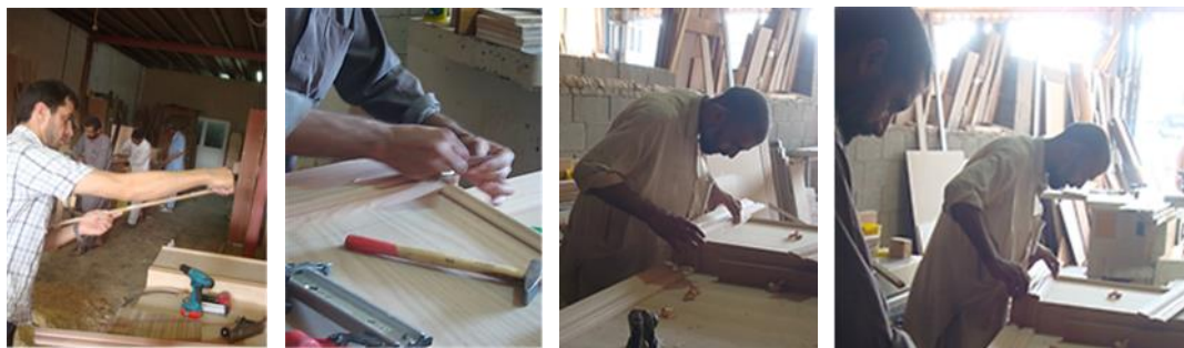
(شكل 20) يوضح ورشة التصنيع ومرحلة تجمع العلب الكونتر لوحات المقاعد
